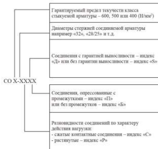
Рисунок А.3 – Схема условных обозначений опрессованных соединений стержней арматуры
