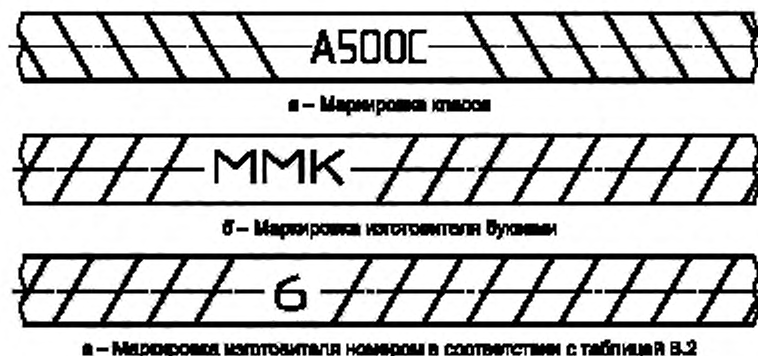
Рисунок В.1 — Маркировка проката надписью
